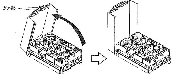
ツメ部をはずし、上へゆっくり持ち上げてください。カバーの開度は2段階構造になっています。カバーを閉める際は、ファイバー、電源コードを挟まないように十分注意してください。
