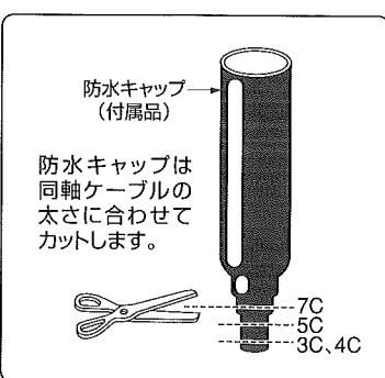
●防水キャップは先に同軸ケーブルに通してください。④ 編組線をめくり返します。
